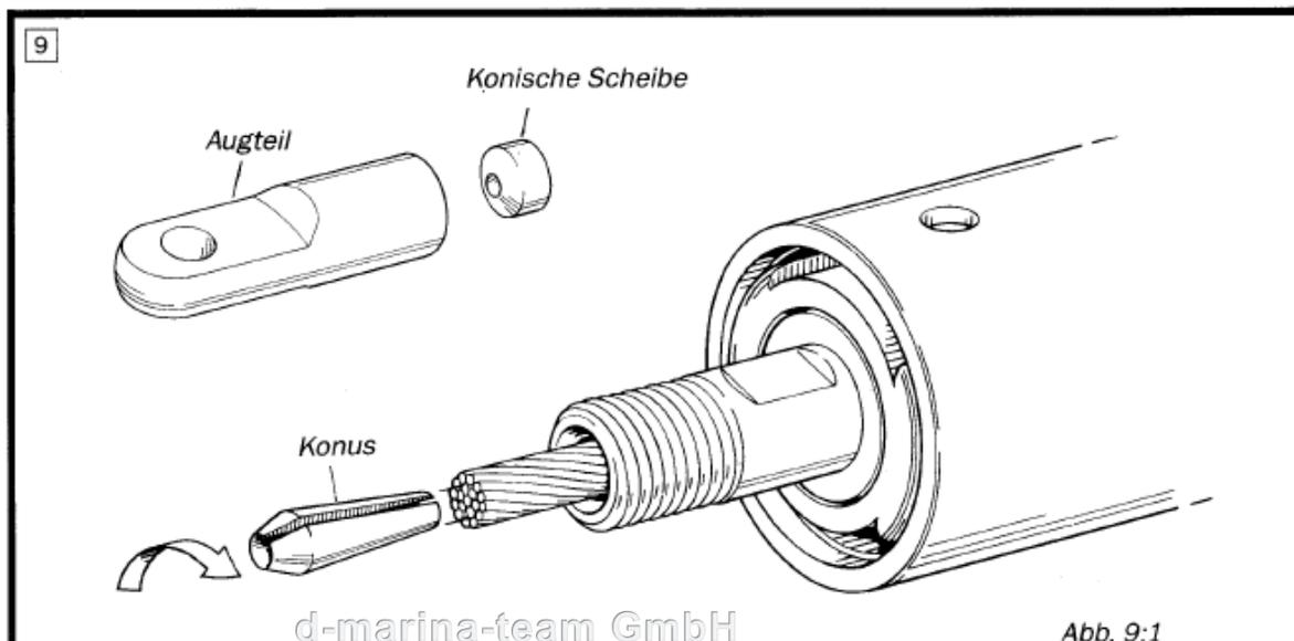
Drehen Sie den Konus über den Drahtseilkern. Drehen Sie die Aussendrähte in der richtigen Drehung um den Konus (von unten gesehen, gegen den Uhrzeigersinn).
