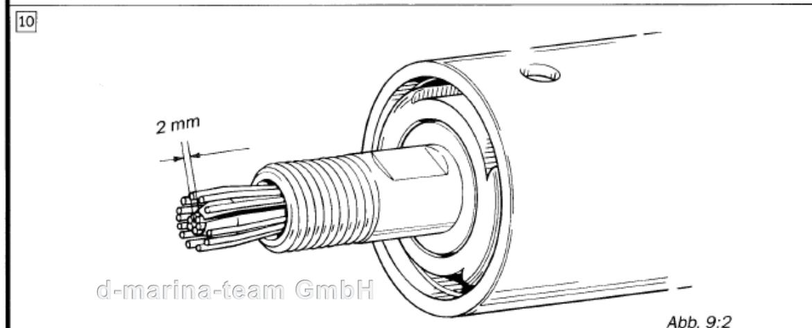
Drücken Sie das Drahtseil mit Konus in den festen Teil des Terminals damit die Aussendrähte, gleichmäßig um den Konus verteilt, fixiert werden.
